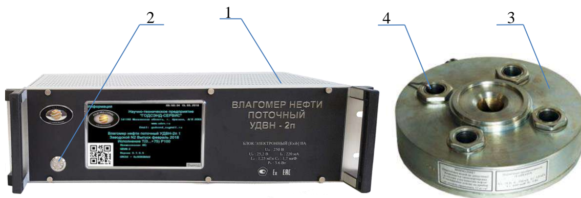
1 - блок электронный; 2 - кнопка включения; 3- первичный преобразователь; 4 – место пломбирования.
